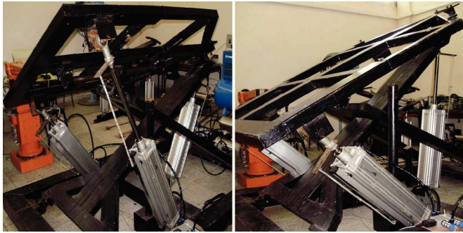
Figura 11: Poses extremas de lado y cabeceo durante experimentos en los límites del espacio de trabajo del robot
