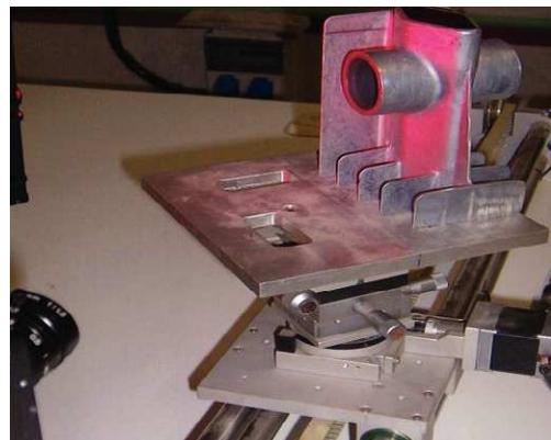
Figura 8: Guía lineal con mesa rotatoria empleada para controlar la rotación y desplazamiento del moyú en las pruebas.
