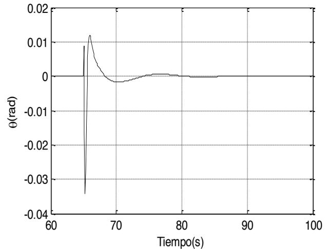
Figura 24: Salida de  $\theta$  frente una variación en forma de pulso - Fuzzy + MPC.
