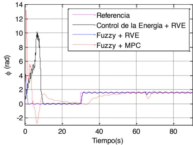
Figura 28: Salida de  $\phi$  para las distintas alternativas de control.
