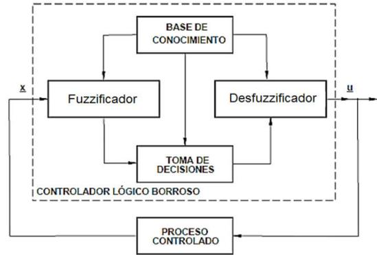
Figura 4: Diagrama en bloques del lazo con regulador borroso.
