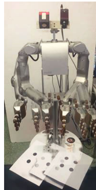
Figura 13: seguimiento de un objeto en movimiento por parte del robot Meka
