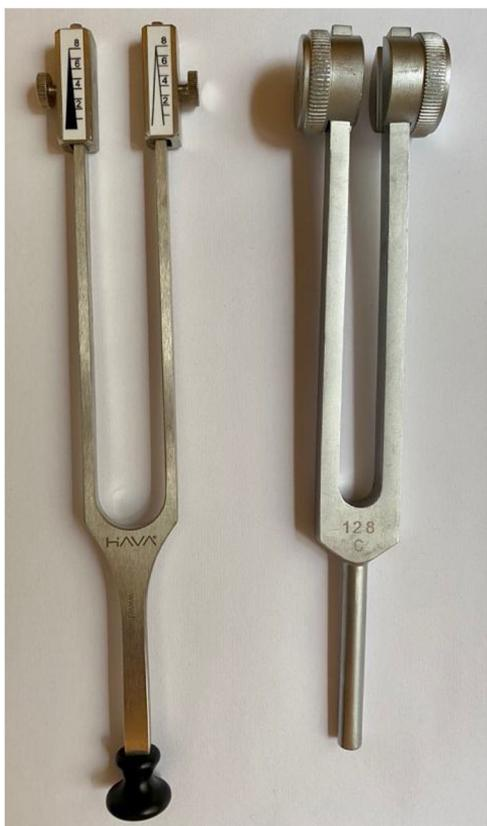
**Figura 1 – Diapasones utilizados en el estudio: a la izquierda, diapasón convencional (DC) (128 Hz); a la derecha, diapasón Rydel-Seiffer (64/128 Hz).**
