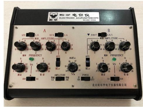
**Figura 1 – Descripción del electroestimulador. El modelo WQ-6F Electronic Acupunctoscope tiene una carga no mayor de 250  $\Omega$  y una carga eléctrica de 40 mA (10 V). La frecuencia de pulso puede ir de 0 a 200 Hz y el ancho de pulso puede ajustarse de 0,2 a 0,8 ms. La fuente de alimentación es corriente continua (4,5 V) insertando 3 baterías tamaño D. Cuenta con 7 salidas divididas en 2 secciones. En la sección A hay 4 salidas y en la sección B hay 3 salidas.**
