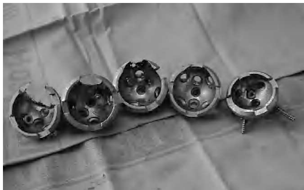
Figura 3. Diferentes grados de abrasión y usura «en ventana» de las copas metálicas.
