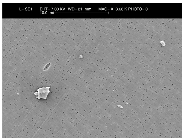
Figura 3 Partículas de polietileno más pequeñas se encuentran en las imágenes del microscopio electrónico de barrido a 20.000×. Asimismo, se puede observar la calidad de la muestra apreciando la correcta digestión y filtración de la misma al mostrarse una imagen nítida y los poros del filtro bien visibles.
