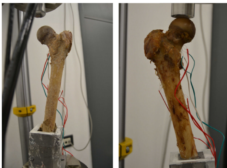
Figura 3 Especimen sobre banco de pruebas experimental con las galgas colocadas para registro de las fuerzas de rotura.
