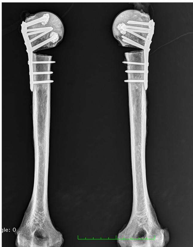
**Figura 4** Radiografía de húmeros con tornillos cementados y osteotomía: el húmero derecho con la configuración clásica (hileras A y E) y el húmero izquierdo con la nueva configuración (hileras B y D).
