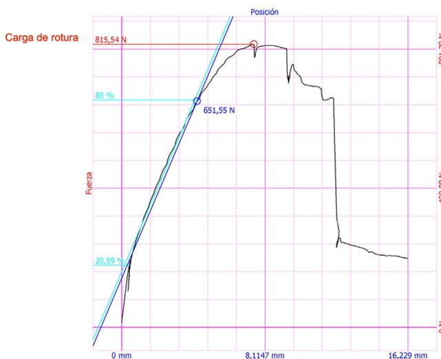
**Figura 6** Gráfica de ensayo a rotura. En la parte superior de la gráfica se marca la carga de rotura.
