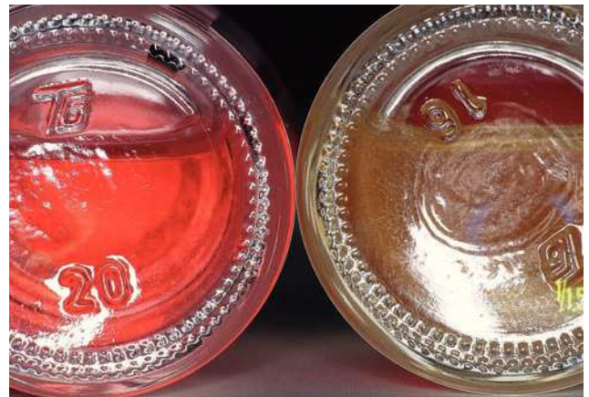
Figura 4. Si el pH baja de 6, el medio rosa (izquierda) pasa a ser amarillo (derecha).
