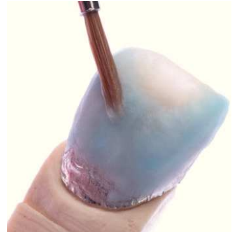
Fig. 11. La segunda cocción se limita normalmente a pequeñas correcciones de la forma mediante una mezcla de masas incisal y transparente, y tiene lugar individualmente sobre el muñón en cuestión, no sobre el modelo.
