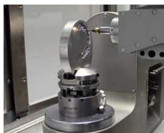
Fig. 3. En el caso de las aleaciones de CoCr, la facilidad de procesamiento mecánico y la buena calidad del material son determinantes para la mecanización (fotografía: tecnología CAD/CAM R+K).
