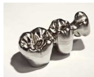
Fig. 5. El fresado de aleaciones de CoCr es más exigente que el del dióxido de zirconio (fotografía: Heraeus).
