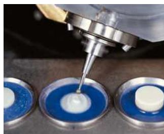
Fig. 9. Mecanización de máxima precisión de bloques de cerámica de silicatos (fotografía: KaVo).
