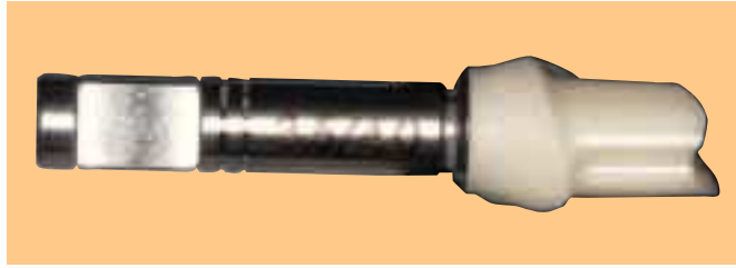
Fig. 9. La junta adhesiva está repasada limpiamente y mide sólo aproximadamente 30 \mu\text{m} .
