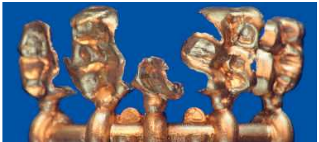
Figs. 1 a 3. Las aleaciones de metales nobles y los inlays se ajustan con un tamaño un poco más pequeño, dado que de este modo los inlays se agarran más fácilmente al istmo y así se ajustan mejor. El control de la expansión en este caso se sitúa en 65% de líquido.
