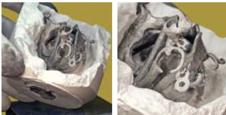
Figs. 15 y 16. El desmuflado tiene lugar mediante chorreado cuidadoso de las estructuras coladas con corindón.
