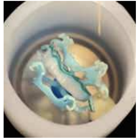
Fig. 11. En la técnica de colado acelerado con la masa de revestimiento especial maruvest Speed puede ajustarse perfectamente el valor de expansión para todas las aleaciones metálicas. Para esqueléticos, el autor utiliza una concentración de aproximadamente 98% líquido para ajustar la expansión.
