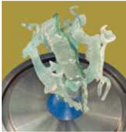
Fig. 10. Es posible colocar los jitos de colado para varias estructuras de esquelético en un cilindro.
