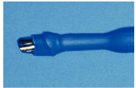
Fig. 5. La protección para el chorreado está correctamente contraída sobre el pilar.
