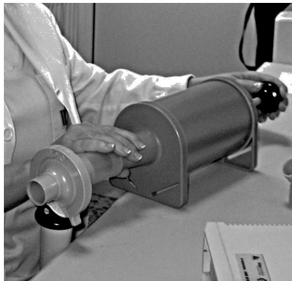
Figura 2. Jeringa de calibración del espirómetro.
