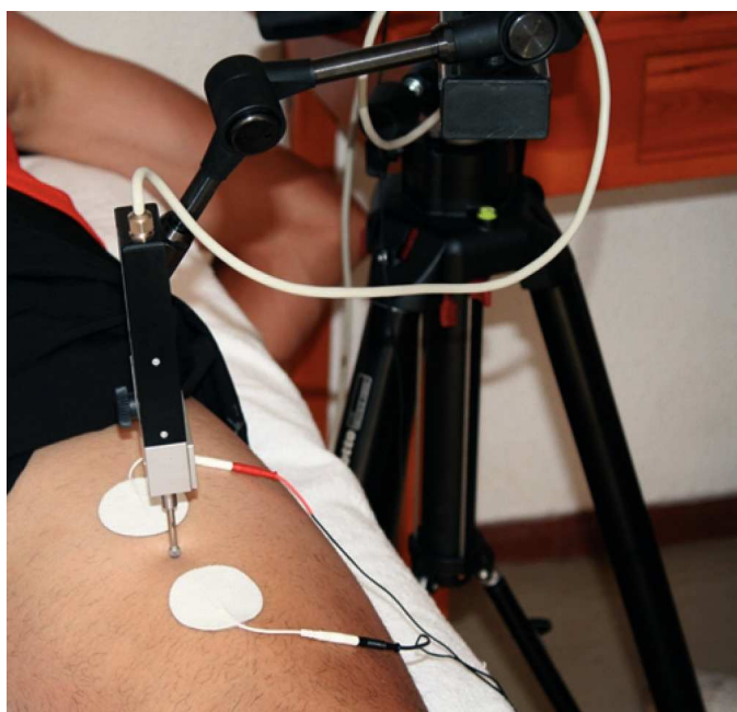
Fig. 3. Ejemplo de colocación del sensor y los electrodos para la evaluación del recto anterior del cuádriceps.
