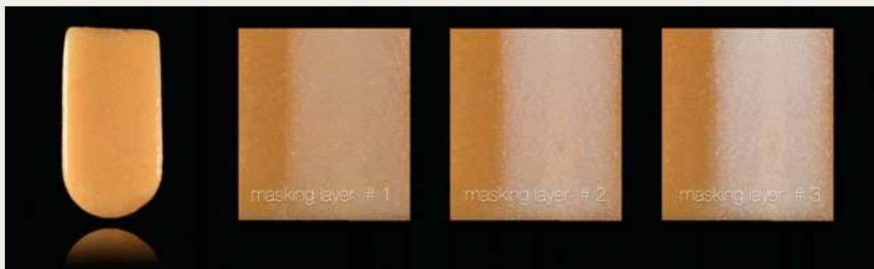
Figura 4 Capas finas secuenciales de enmascaramiento; cada capa se cuece de forma individualizada hasta conseguir la opacificación deseada del sustrato de prueba.
